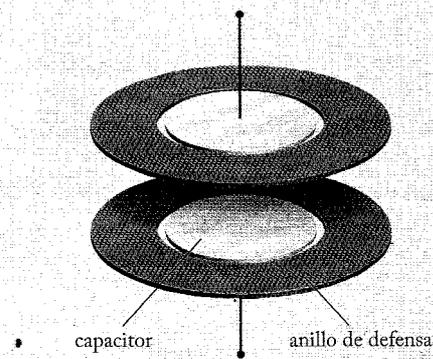
**FIGURA 26.21** Capacitor con anillos de defensa.
