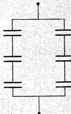
FIGURA 26.28 Seis capacitores idénticos.
