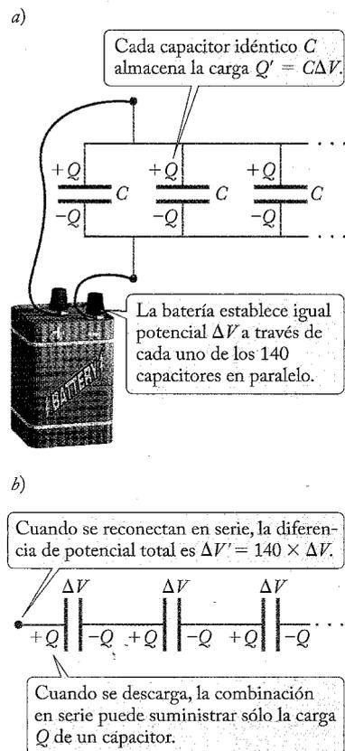
**FIGURA 26.12** a) Primero se conectan los capacitores en paralelo y se cargan con una batería. b) Después los capacitores de conectan en serie.
