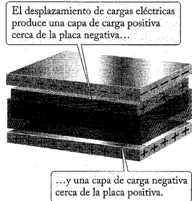
FIGURA 26.16 Las distribuciones de carga positiva (café) y negativa (verde) en la capa de dieléctrico no pueden traslaparse con exactitud. Entonces, el campo eléctrico ha producido una separación de las cargas.
