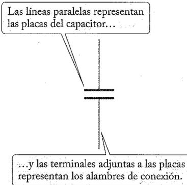
FIGURA 26.6 Símbolo de un capacitor en diagramas eléctricos.
