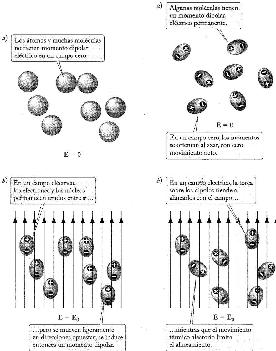
FIGURA 26.14 a) Moléculas no distorsionadas. b) El campo eléctrico produce una distorsión en las moléculas.
