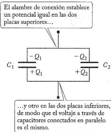
FIGURA 26.7 Dos capacitores conectados en paralelo.
