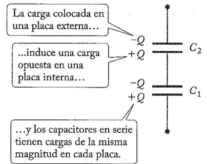
FIGURA 26.9 Dos capacitores conectados en serie.
