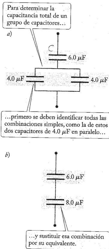
**FIGURA 26.11** a) Los dos capacitores de 4.0 µF (en verde) están conectados en paralelo, y el capacitor de 6.0 µF (naranja) está conectado en serie con estos dos. b) Los dos capacitores de 4.0 µF son equivalentes a un solo capacitor de 8.0 µF, que está conectado en serie con el capacitor de 6.0 µF.
