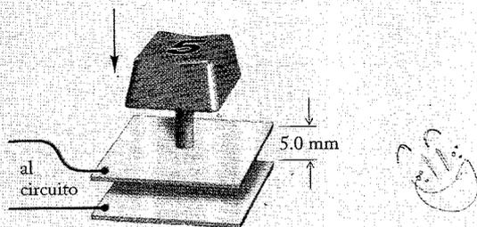
FIGURA 26.24 Interruptor capacitivo de un teclado.
