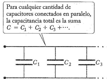
FIGURA 26.8 Varios capacitores conectados en paralelo.
