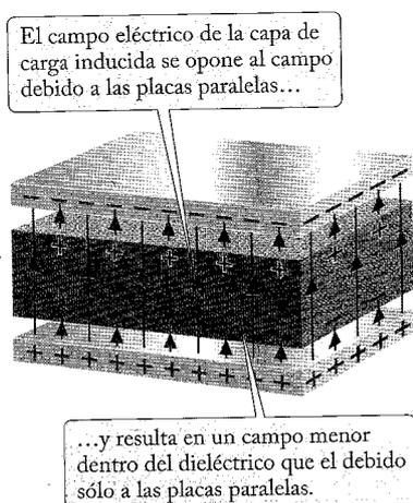
**FIGURA 26.17** Algunas líneas del campo eléctrico terminan en las cargas negativas abajo de la capa de dieléctrico. La densidad de las líneas de campo es menor en el dieléctrico que en los espacios vacíos adyacentes a las placas; esto es, el campo eléctrico es menor.
