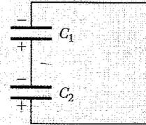
FIGURA 26.31 Dos capacitores conectados en serie, después de haberlos cargado.
