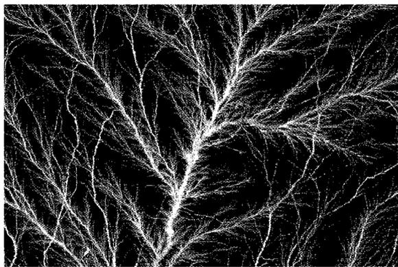
**FIGURA 26.18** El rompimiento eléctrico en un bloque de plexiglás, en un campo eléctrico muy intenso, causó diminutas perforaciones en el bloque y formó esta bella figura arbórea.
