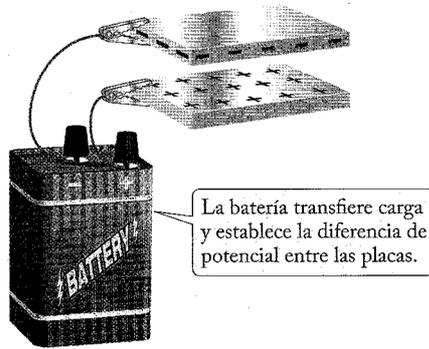
**FIGURA 26.4** Un capacitor de dos conductores conectado a las terminales de una batería.
