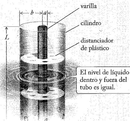
FIGURA 26.36 Un sensor de capacitancia para nivel de líquidos.
