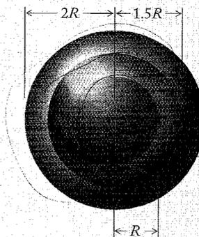
FIGURA 26.38 Capacitor esférico lleno parcialmente con dieléctrico.
