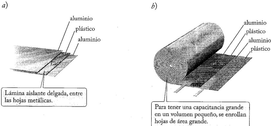
FIGURA 26.3 a) Hojas de aluminio separadas por una hoja de plástico. b) Capacitor enrollado.
