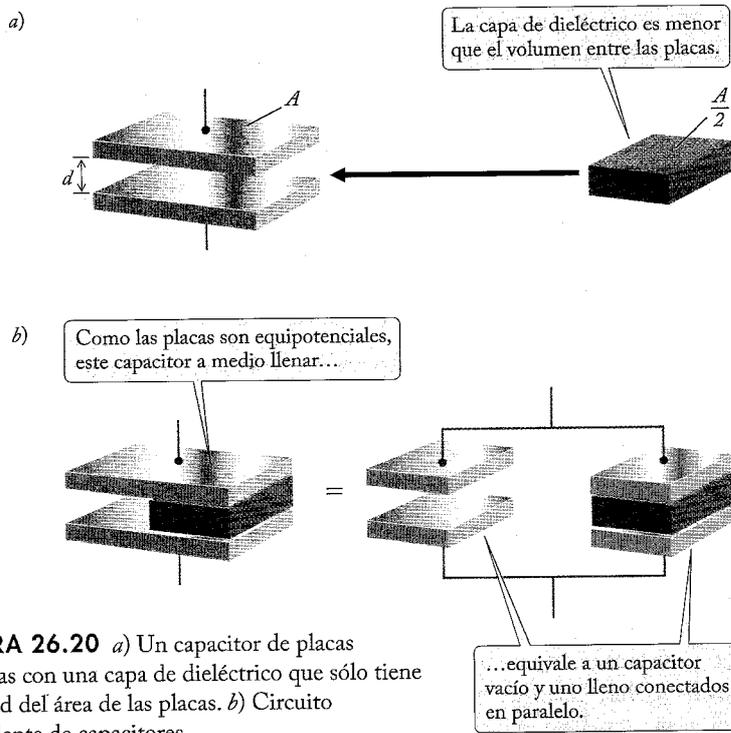
**FIGURA 26.20** a) Un capacitor de placas paralelas con una capa de dieléctrico que sólo tiene la mitad del área de las placas. b) Circuito equivalente de capacitores.
