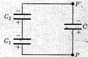
FIGURA 26.32 Tres capacitores conectados después de haberlos cargado.
