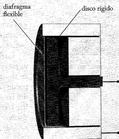
**FIGURA 1** Un micrófono de capacitor. Cuando una onda sonora choca con el diafragma flexible, se modifica la distancia entre el diafragma y el disco rígido.
